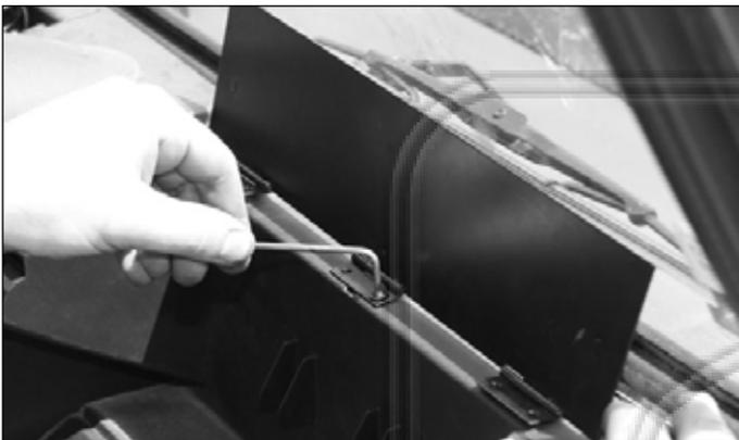
5. Montageplatte positionieren und anschrauben
