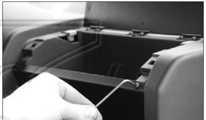
6. Frontplatte montieren (5 Schrauben !)
