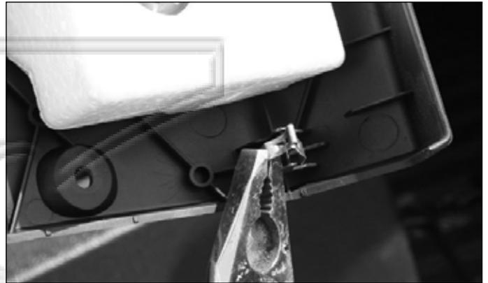
2. Halteklammern und Styropor entfernen
